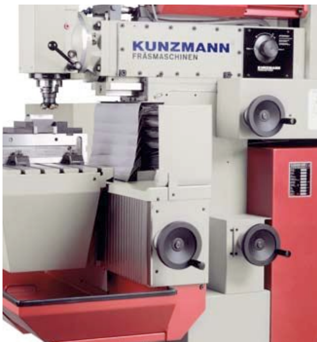
Ergonomisch angeordnete Sicherheitshandräder zum manuellen Verfahren
