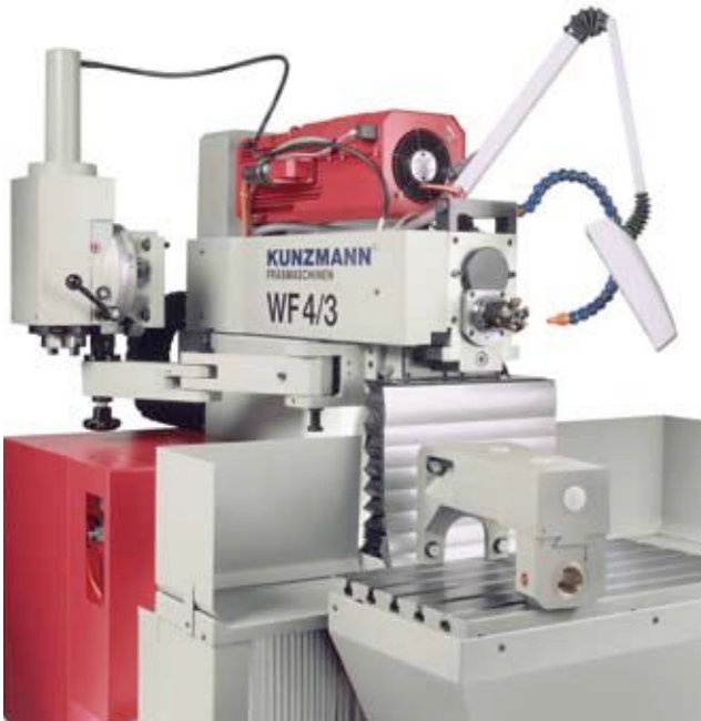
Horizontale Bearbeitung mit oder ohne Gegenhalter
